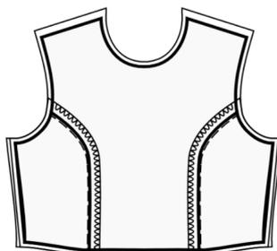
4. Coser pinzas en las espaldas. Comience desde el borde de la tela y cosa hacia la esquina de la pinza con una puntada estrecha. No pespunte, deja hilos largos y haz un nudo. Presione hacia el centro de la espalda (vea la figura de la derecha).
